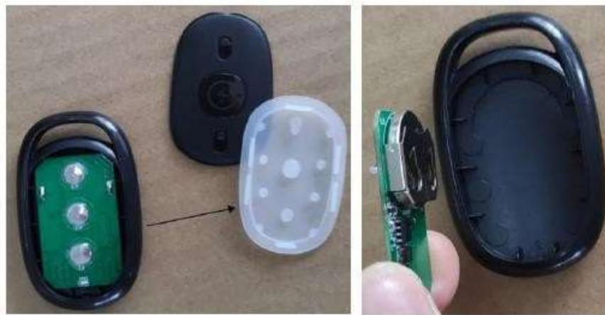
(3) Rimuovere la batteria a celle rotonde e sostituirla con il modello: CR2032.
