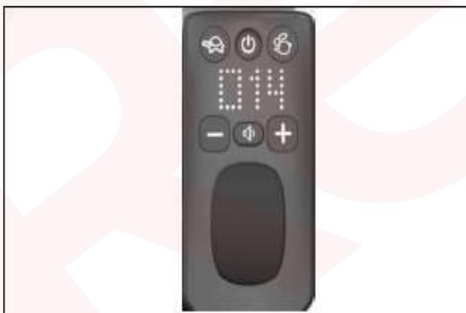
Premere simultaneamente i pulsanti “tartaruga” e “-” per regolare l’angolazione del sedile verso il basso. Premere simultaneamente i tasti “coniglio” e “+” per regolare l’angolazione del sedile verso l’alto. Il range di regolazione va da 0 a 20 gradi.
