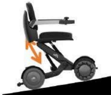
quando la carrozzina va in salita, regola automaticamente la pendenza del sedile in modo che l'inclinazione del sedile rispetto al livello rimanga invariata. Nella fase di autoregolazione la velocità della carrozzina subisce una leggera decelerazione (fenomeno normale). se la pendenza è troppo ripida, superiore a 15 gradi, la macchina si ferma ed emette un allarme
