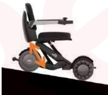
quando la carrozzina va in discesa, regola automaticamente la pendenza del sedile in modo che l'inclinazione del sedile rispetto al livello rimanga invariata. Nella fase di autoregolazione la velocità della carrozzina subisce una leggera decelerazione (fenomeno normale). se la pendenza è troppo ripida, superiore a 15 gradi, la macchina si ferma ed emette un allarme
