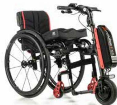
Ruota di trazione da 14", copertone pneumatico, montato su una carrozzina con telaio anteriore fisso
