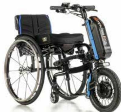
Ruota di trazione da 8,5", copertone pieno, montato su una carrozzina con telaio anteriore swing-away, con staffe di ancoraggio più lunghe per arrivare sotto il telaio e montante del manubrio a collo di cigno.
