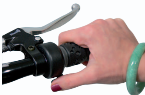
Acceleratore a pollice (di serie). In alternativa è disponibile l'acceleratore a manopola. Finger control accelerator. On request it is available a gas throttle.
