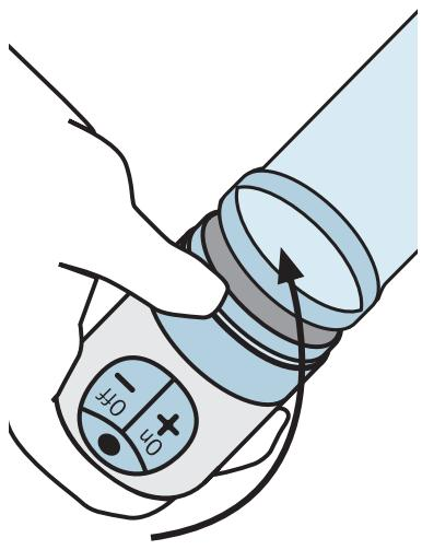
4) Encaje el cono en el extremo abierto opuesto del cilindro de vidrio acrílico.
