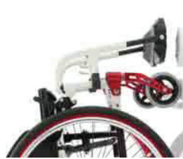
Tre angoli per il telaio anteriore con pedane estraibili: 95°
